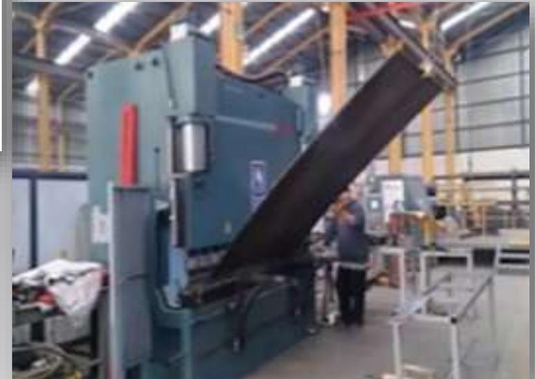
**PROCESO DE DOBLADO (TUBOS, LÁMINA, SOLERA)**
